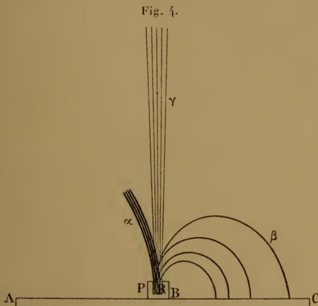
(0<sup>mm</sup>, 1 d'épaisseur), les rayons  $\alpha$  sont en très grande partie supprimés, les rayons  $\beta$  le sont bien moins et les rayons  $\gamma$  ne semblent pas absorbés notablement.
